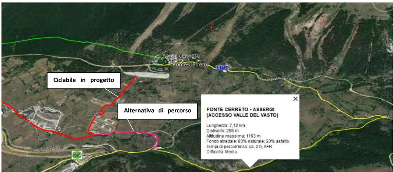
Figura 71 Sistema ciclabili Parco del Gran Sasso – Monti della Laga. In rosso la ciclopedonale in progetto, in rosa il ricongiungimento previsto al percorso bike del Parco (in giallo)
