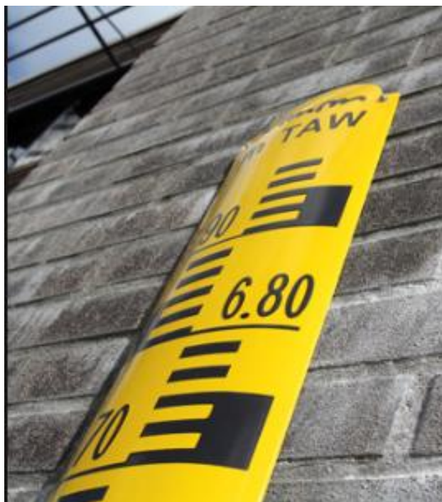
Figura 6: asta idrometrica di sicurezza
