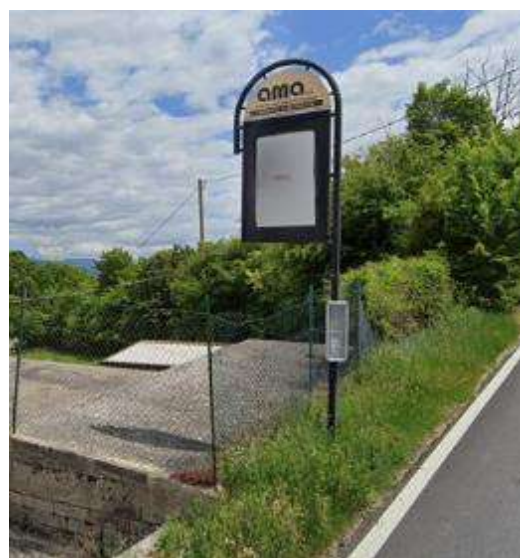
Figura 36 – Fermata in Via L'Aquila – Pianola; inadeguata per motivi di sicurezza e di accessibilità, è assente anche la pavimentazione
